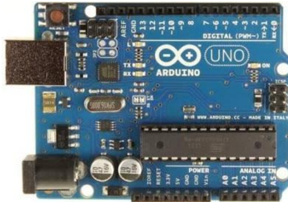
Gambar 2.11 Arduino Uno R3
