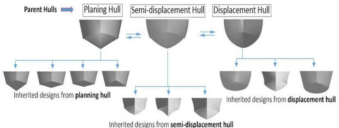
Gambar 2.6. Bentuk-bentuk lambung kapal untuk kategori *displacement hull*, *planing hull*, *semi-planing hull*
