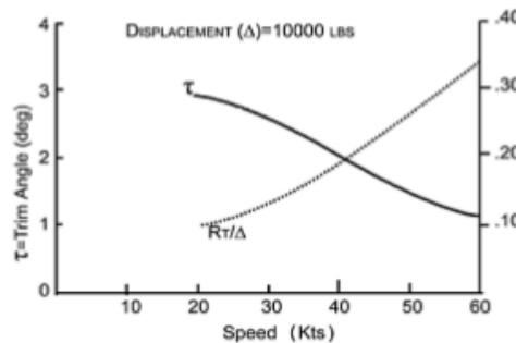
Gambar 2.9. Perhitungan perbandingan antara sudut tirm dan kecepatan.
