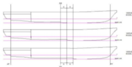
Gambar 2.10. Posisi *step hull* di *midship* lebih optimal dibanding dengan posisi yang lebih ke haluan.
