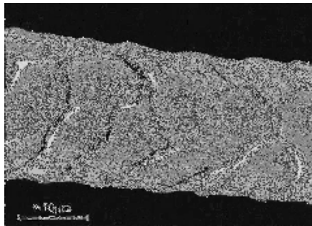
Gambar 2.20 Scanning Electron Micrograph (SEM) dari serat, menunjukkan sel kutikula yang saling membungkus.
