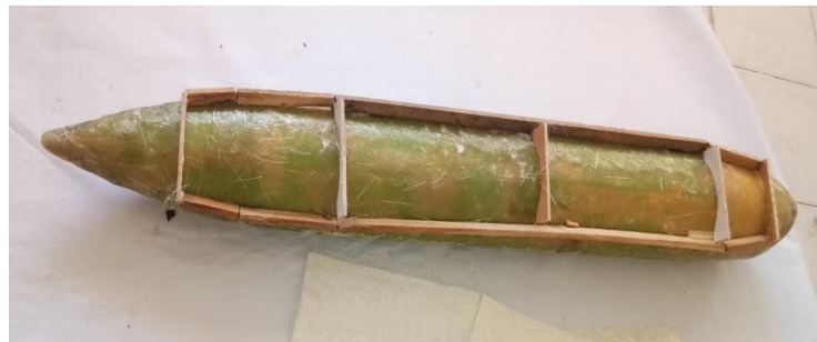
Gambar 4.7 Pemasangan kayu pada lapisan ketiga
