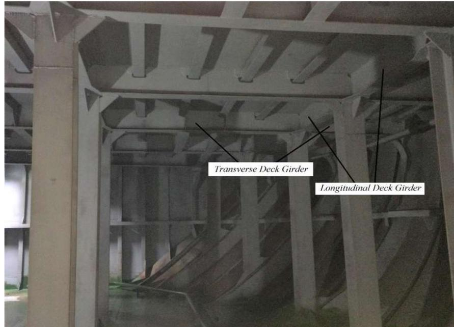
Gambar 2.5 Konstruksi geladak kapal kontainer
