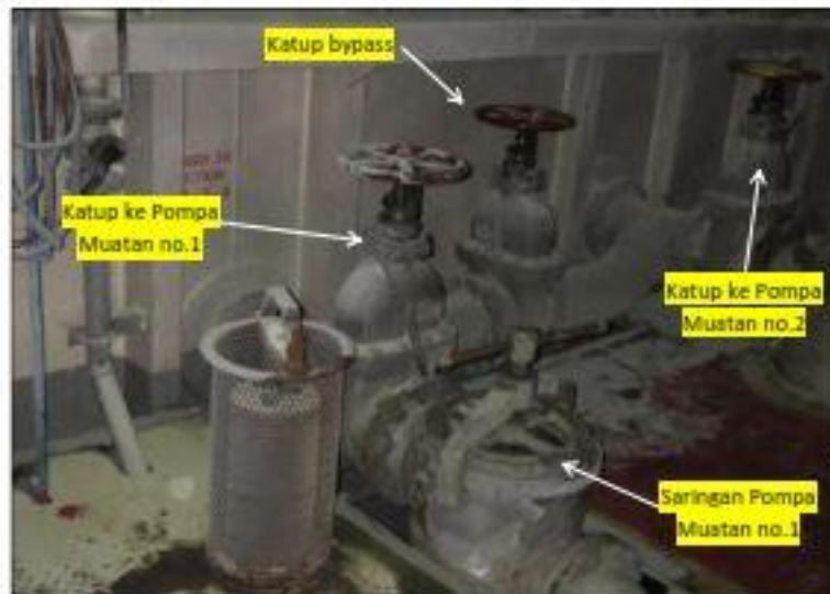
Gambar 1-6: Katup-katup pada sisi isap pompa muatan dalam posisi terbuka dan strainer pompa muatan yang telah ditutup kembali
