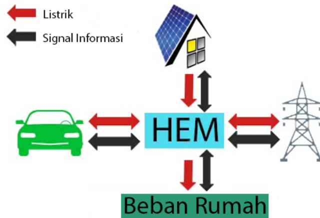
Gambar 2.10. Diagram blok dari sistem manajemen energi untuk rumah tangga.
