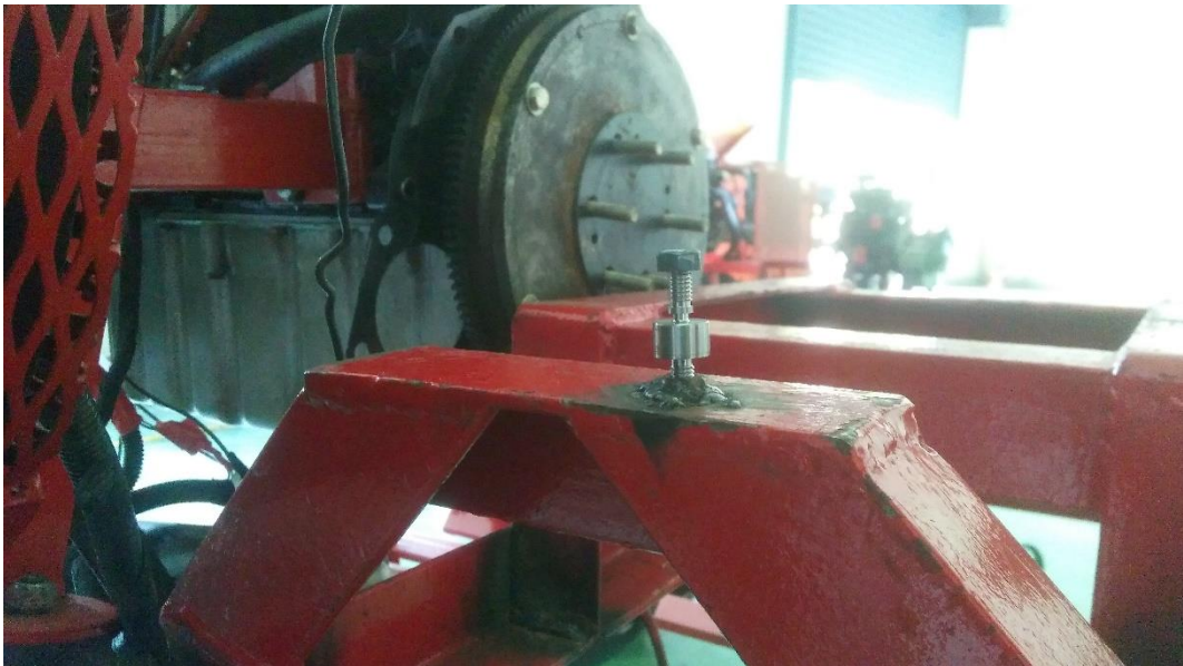
Pemasangan Load cell ke dudukan meisin
