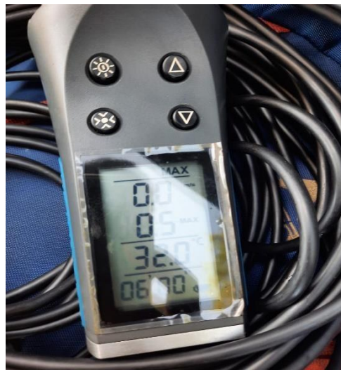
Gambar hasil pengukuran aliran menggunakan Currenet Meter Flowwatch
