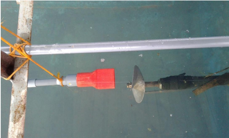
Gambar penempatan nosel inlet dengan jarak 5 cm terhadap propeller kapal
