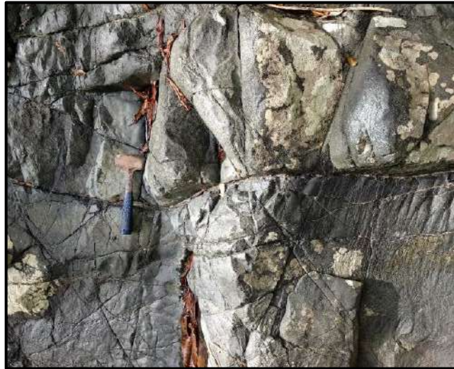
Gambar 2.9 Kenampakan kekar sistematis pada litologi Basalt (Sumber : Kaharuddin MS dkk, 2020)
