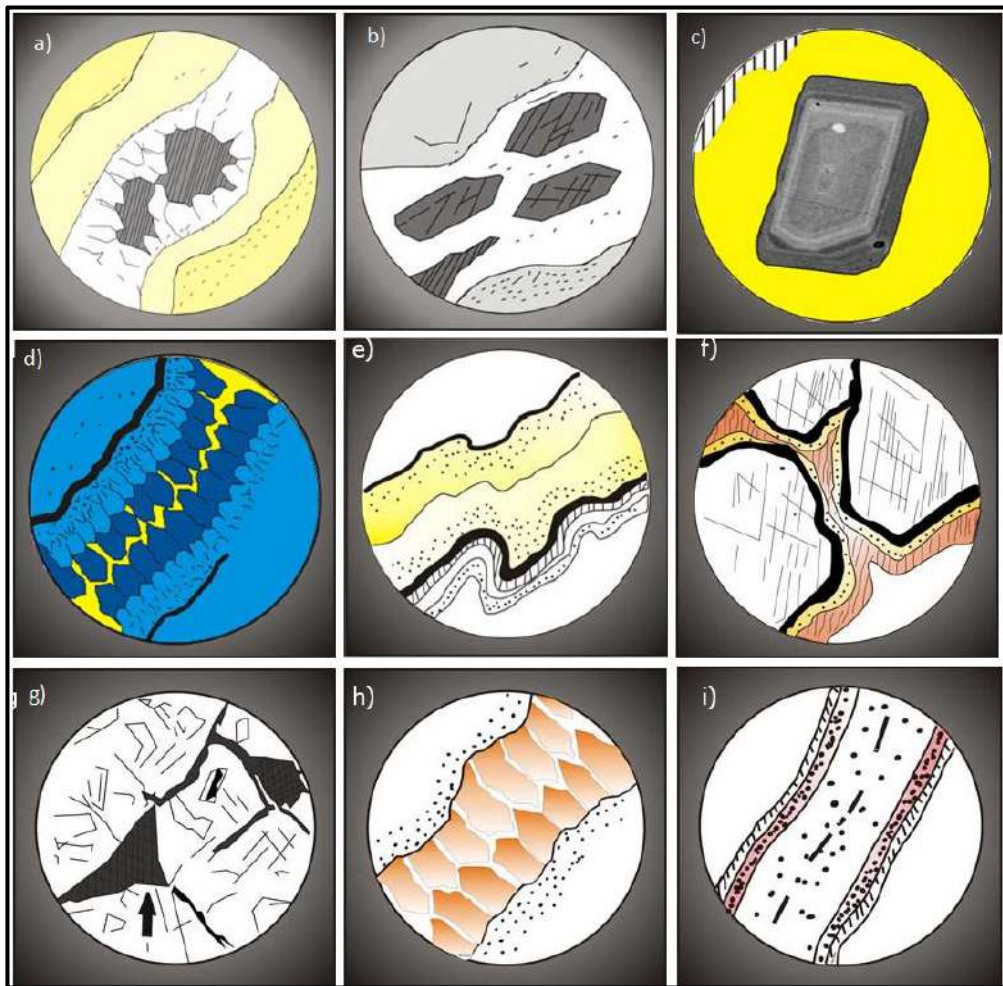
Gambar 2.13 Gambar yang menunjukkan beberapa kenampakan tekstur pengisian. A) Vuggy atau rongga sisa pengisian, b). Kristal euhedral, c). Kristal zoning, d). Gradasi ukuran Kristal, e). Tekstur crutiform , f). Tekstur cockade , g). Tekstur triangular, h). Comb structure , i). Pelapisan simetris
