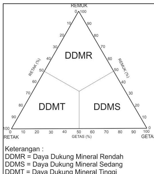
Gambar 2.17 Klasifikasi menggunakan segitiga trinery untuk menentukan daya dukung mineral berdasarkan persebaran tingkat kerusakannya (Umar,2018)
