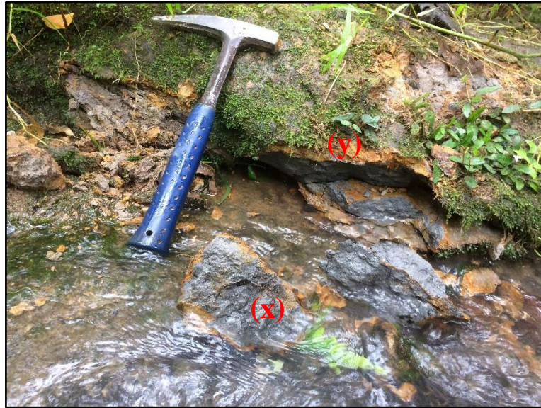
Gambar 2.3 Pelapukan kimia yang menunjukkan perubahan warna pada litologi batupasir, warna abu-abu (x) menjadi warna kuning kecoklatan (y) pada stasiun 28 daerah Bontomangiping yang difoto relatif ke arah N 37° E.
