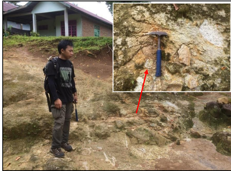
Gambar 2.10 Pelapukan kimia yang menunjukkan perubahan warna pada litologi tufa, pada stasiun 41 daerah Bippajing difoto relatif arah N 13° E.
