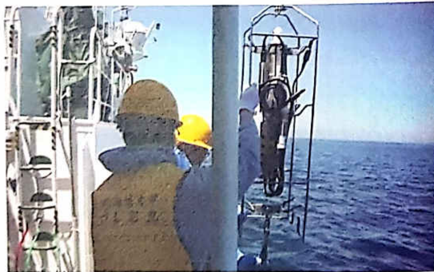
Gambar 4.12. Instrumen Conductivity Temperature Depth (CTD). Gambar Diambil Dalam Survei Lapangan dengan Menggunakan Kapal Latih "Ushio Maru" Hokkaido University Tahun 2012.
