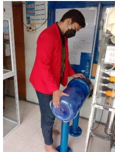
Dicuci galon dengan mesin sikat selama 30 detik (1 kali pencucian)
