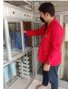
Dibilas galon dengan mesin semprot dalam rentang waktu 5-10 detik
