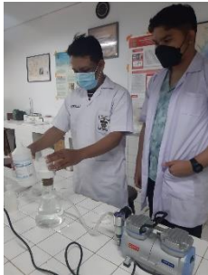
Ditutup alat vacum setelah proses penuangan
