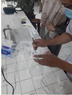
Dipasang kertas saring ke dalam alat vacum
