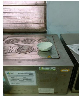
Menguapkan filtrate menggunakan penangas air
