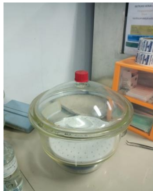
Dinginkan menggunakan desikator
