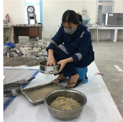
Proses Penyaringan Material
