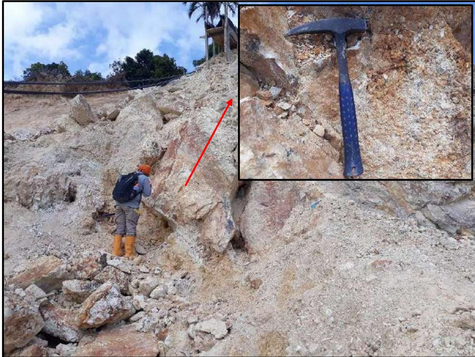
**Gambar 2.12** Singkapan breksi hidrotermal yang berada di Bok “Y” daerah penelitian pada satuan 25F.
