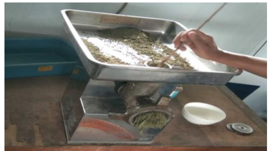
Pencetakan adonan pakan dengan mesin pencetak pellet
