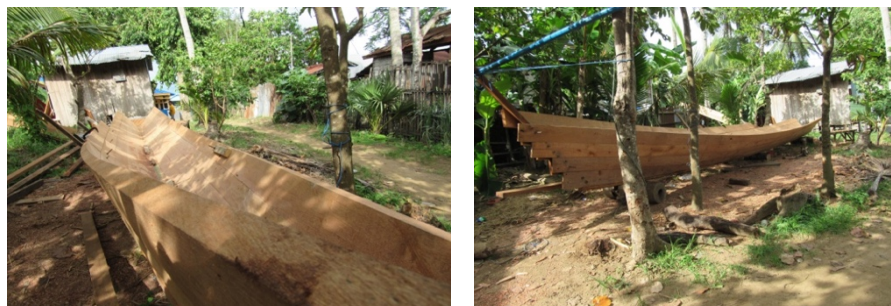
Gambar 5. Proses Pembuatan Kapal Motor untuk mesin 15-40 PK oleh Nelayan Non-Lokal di Pesisir Merauke.
