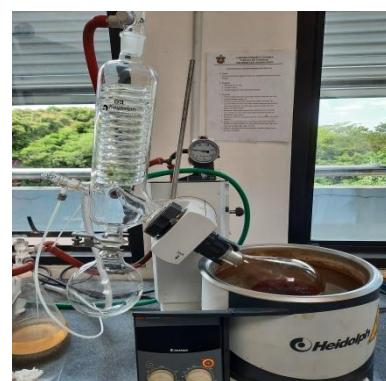
**Gambar 23.** Proses Penguapan Pelarut
