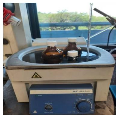
**Gambar 21.** Proses ekstraksi dengan digesti
