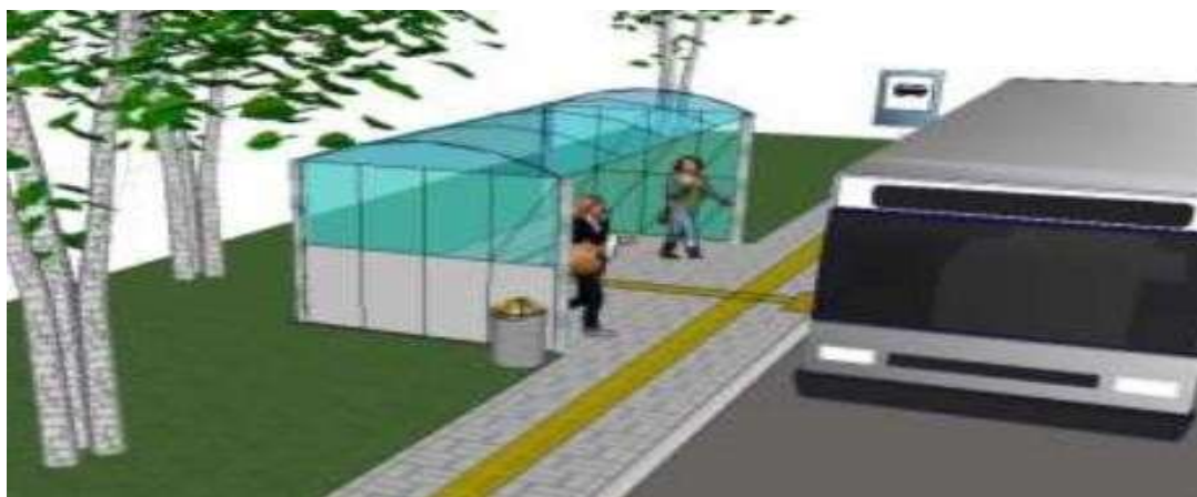
Gambar 14. Standar Halte yang Terletak di Belakang Jalur Pedestrian (Sumber: SE Menteri PUPR Nomor : 02/SE/M/2018)
