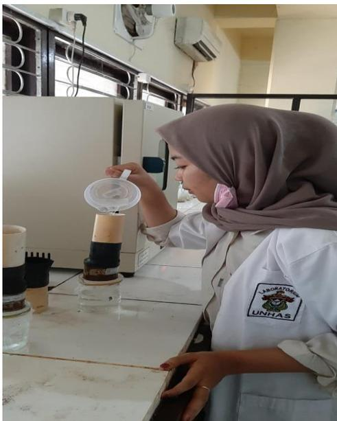
**Pengujian Permeabilitas Tanah**
