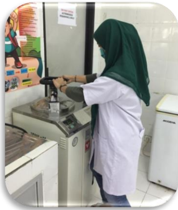
Chip umbi gembili dimasukkan ke dalam autoclave
