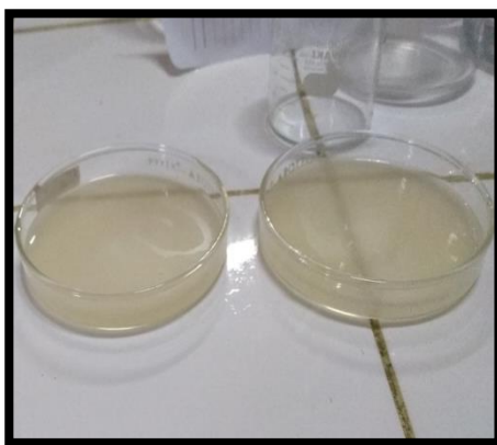
Proses Pencetakan Bioplastik
