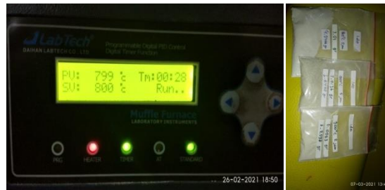
Sintering bubuk kerang darah
