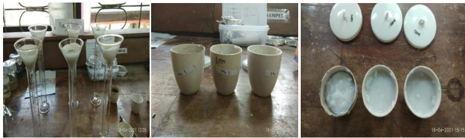
Penyaringan endapan menggunakan kertas saring
