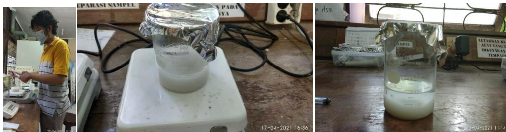
Titrasi dan pengendapan selama semalaman (18 jam)
