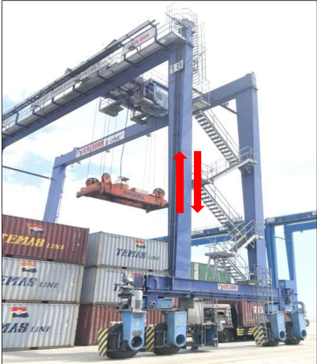
Gambar 2.9 Skema Gerakan Hoist pada RTG Crane
