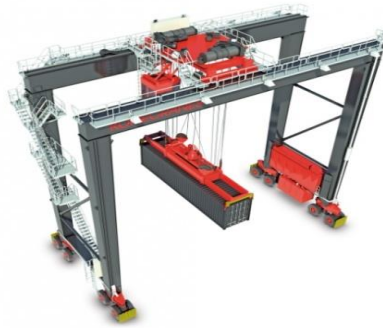
Gambar 2.2 Alat Angkat Rubber Tyred Gantry Crane (Sumber: http://image.google.co.id )
