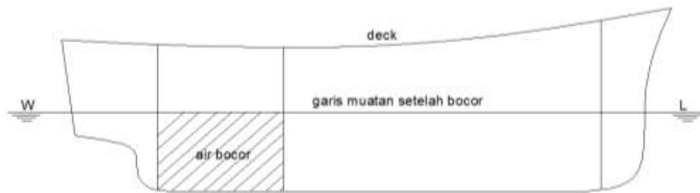
Gambar 13 Kapal yang mengalami kobocoran
