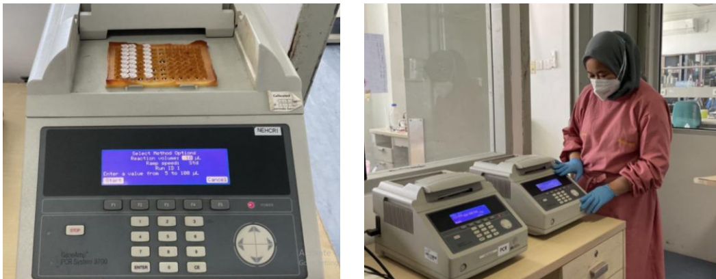
Gambar 21. Proses denaturasi, annealing dan extention dengan alat PCR (Thermal Cycle)
