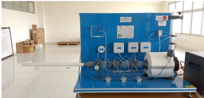
Gambar B1. Pengambilan data pada diameter pipa saluran masuk 1''
