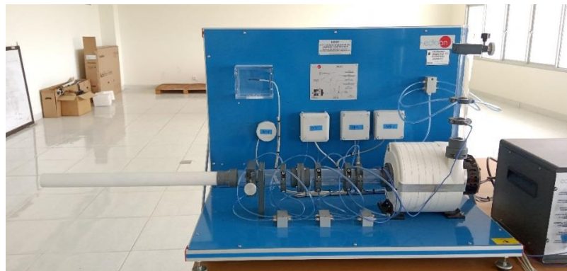
Gambar B2. Pengambilan data pada diameter pipa saluran masuk 1.5''
