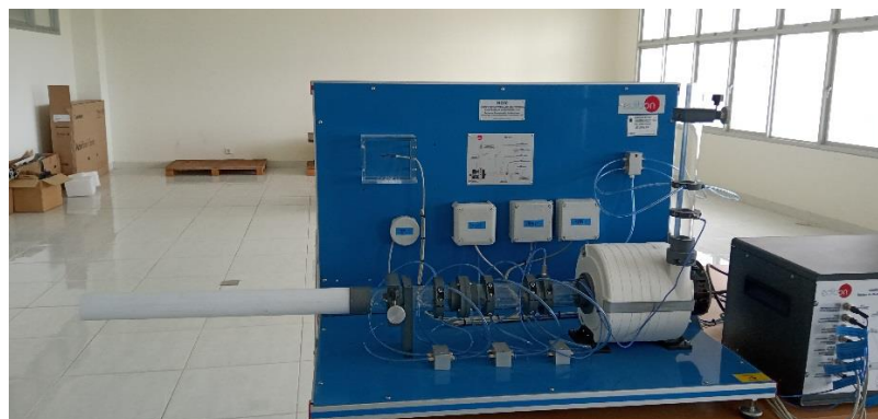
Gambar B3. Pengambilan data pada diameter pipa saluran masuk 2''
