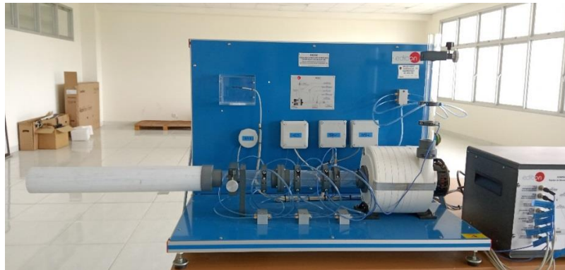
Gambar B5. Pengambilan data pada diameter pipa saluran masuk 3''
