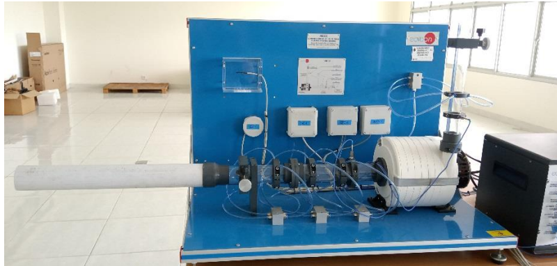
Gambar B4. Pengambilan data pada diameter pipa saluran masuk 2.5''
