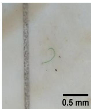
Gambar 4. Mikroplastik Jenis line dan bentuk 0,526 mm pada perbesaran 45×
