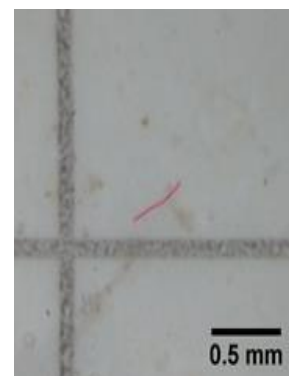
Gambar 5. Mikroplastik Jenis line dan bentuk 0,405 mm pada perbesaran 45×.
