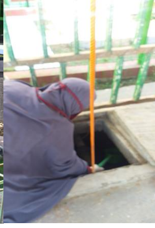
Gambar 3. Pengambilan sampel air limbah di inlet
