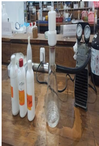
Gambar 4. Penyaringan sampel air limbah menggunakan Vacum Pump
