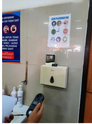
Gambar 2. Pengukuran suhu udara dalam ruang.
