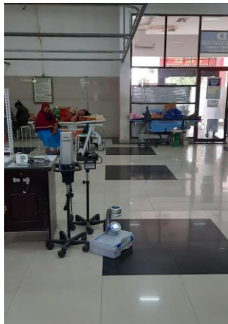
Gambar 5. Pengambilan sampel udara menggunakan microbial air sampler
