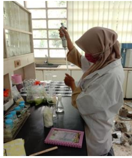
Pencampuran cairan dengan carbon aktif lalu kocok 2 menit
