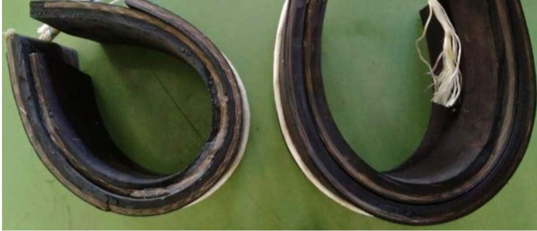
Perbandingan Fisik secara Visual Potongan Sampel Lama dan Sampel Baru Belt 2BC 3B
