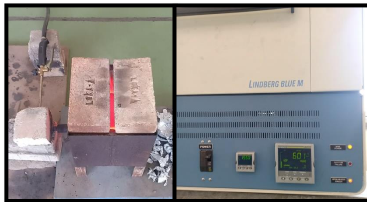
Melebur Aluminium 6061 dan Memanaskan CNT sampai temperatur 500°C, 600°C, dan 700°C dengan penahanan selama 5 menit
