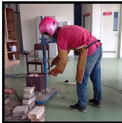
Mencampurkan Aluminium Cair dan CNT yang telah dipanaskan
