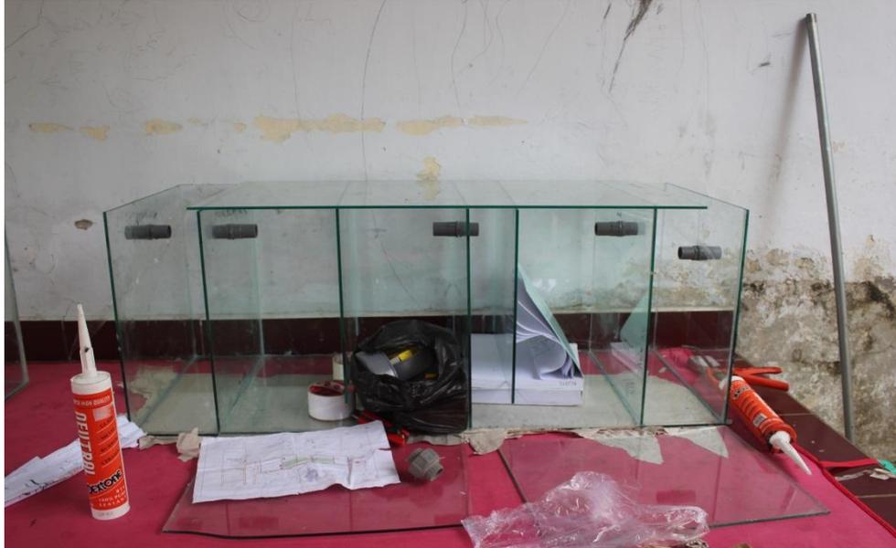
*Gambar 6. Alat dan Bahan yang digunakan untuk pembuatan reaktor.*
