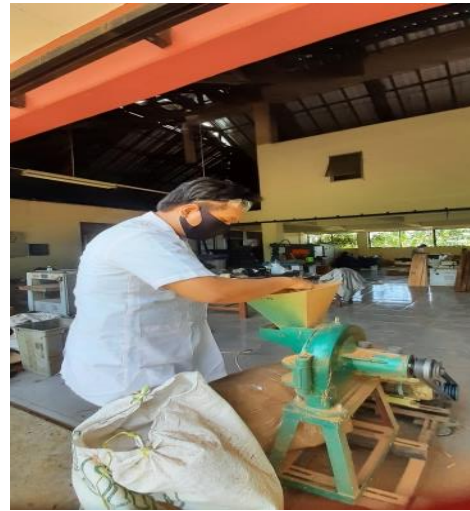
Gambar 9. Penggilingan bahan baku sabut kelapa, serutan kayu sengon dan ampas tahu
