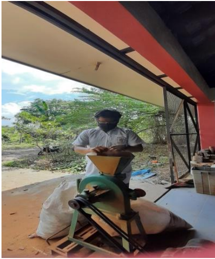
Gambar 9. Penggilingan bahan baku sabut kelapa, serutan kayu sengon dan ampas tahu
