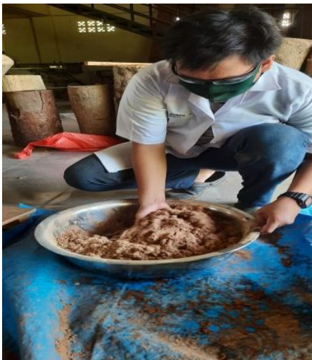
Gambar 9. Penggilingan bahan baku sabut kelapa, serutan kayu sengon dan ampas tahu
