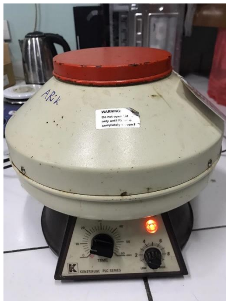
Gambar 37 Proses Pemisahan Serum menggunakan Sentrifuge
