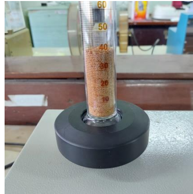
Gambar 21. Evaluasi Bobot jenis nyata, mampat dan porositas. Alat Tap density dual holder (Merek Lokal TD-LO-2H-01).
