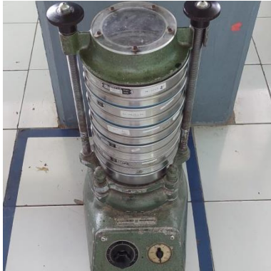
Gambar 13. Evaluasi distribusi partikel granul. Alat Shieve Shaker (Merek Lokal SS-HB-EM-01).
