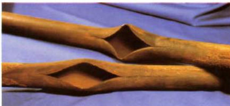
Gambar 2.24 Kegagalan pada superheater tube akibat creep ( long-term overheating ) (Port & Herro, 1991).
