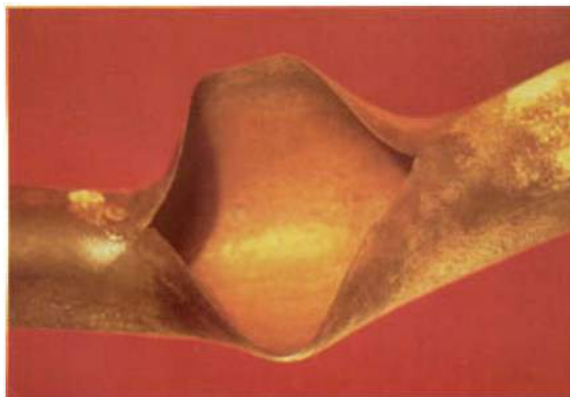
Gambar 2.23 Short-term overheating , di mana tonjolan terjadi sebelum pecah (Port & Herro, 1991).
