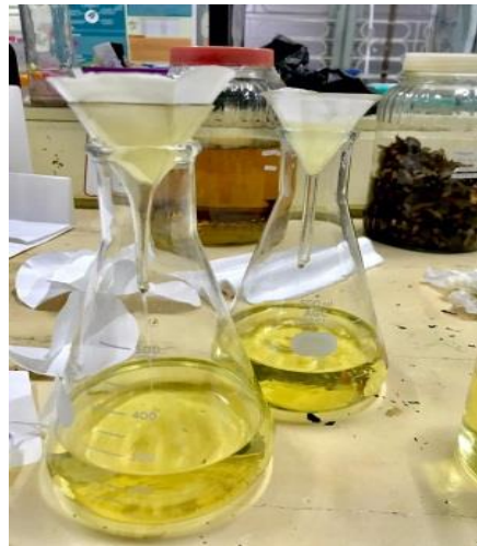
Gambar 12. Proses penyaringan sampel hasil maserasi 7 x 24 jam
