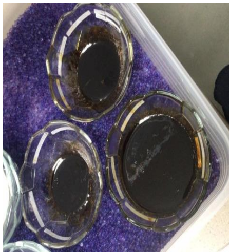
Gambar 13. Hasil remaserasi diuapkan menggunakan rotary evaporator
