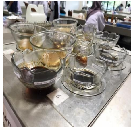
Gambar 14. Penguapan ekstrak cair menggunakan waterbath .
