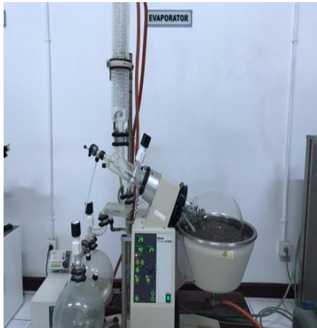
Gambar 13. Hasil remaserasi diuapkan menggunakan rotary evaporator
