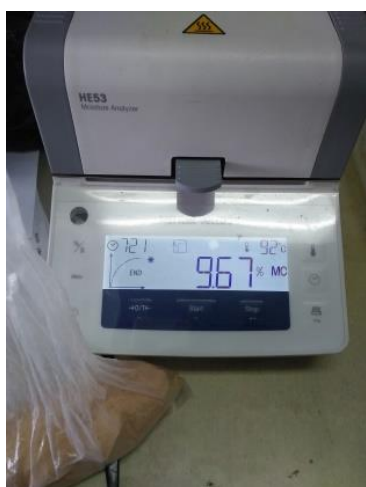
Gambar 20. Hasil Pengujian Kadar Air
