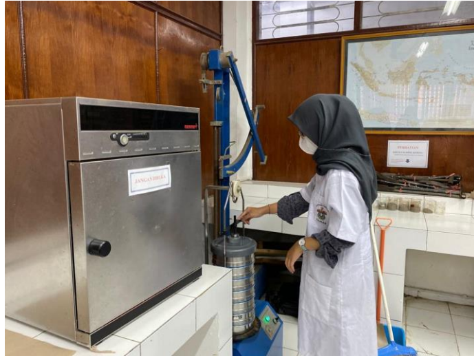
Gambar 21. Mengayak sedimen menggunakan sieve net diameter 0.0625 - 2 mm
