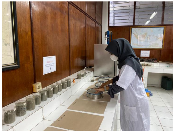
Gambar 22. Memisahkan sedimen dari masing- masing sieve net
