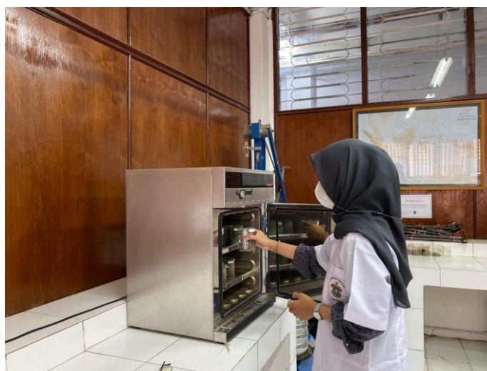
Gambar 20. Mengeringkan sedimen menggunakan oven
