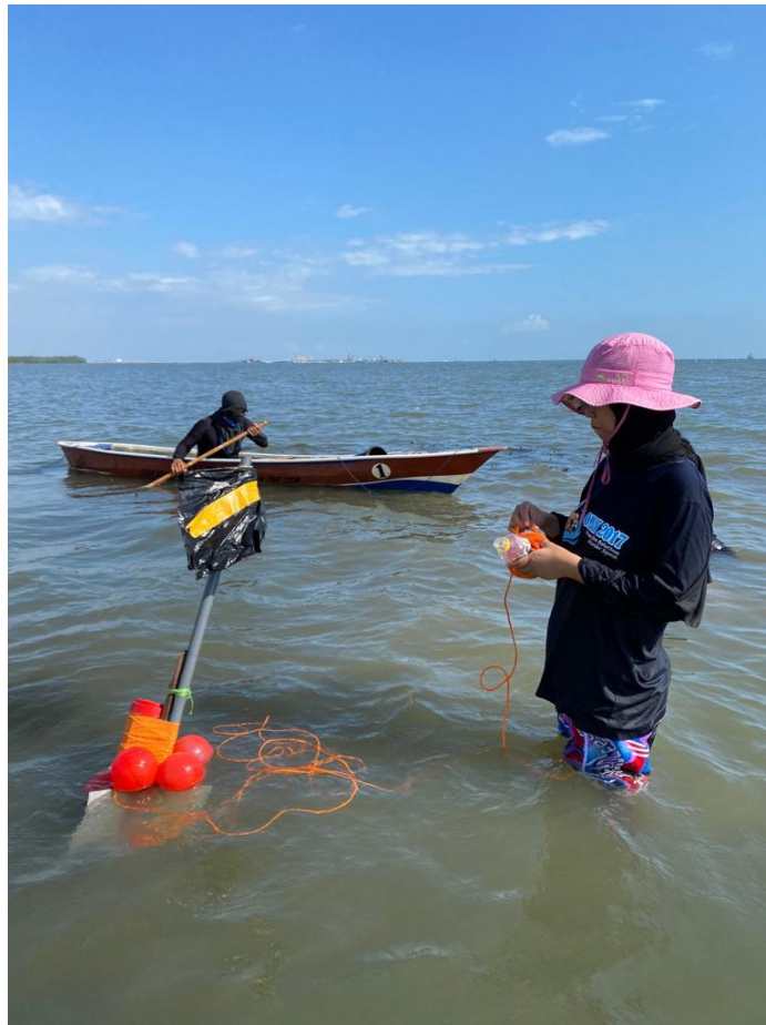
Gambar 14. Pengukuran arus saat pasang menggunakan layang-layang arus
