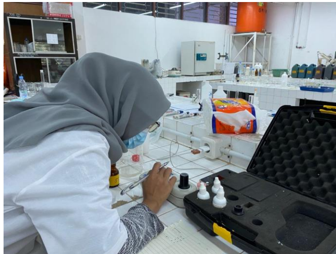
Gambar 18. Pengukuran kekeruhan menggunakan turbidimeter
