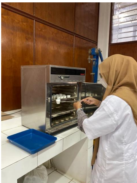
Gambar 26. Mengeringkan sedimen menggunakan oven sebelum melakukan pembakaran
