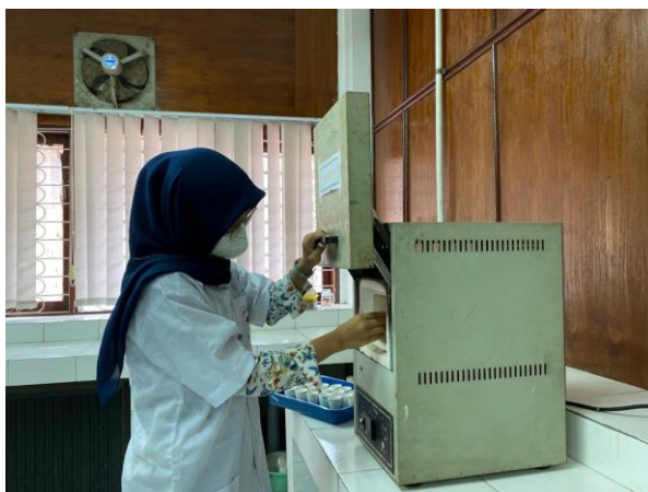
Gambar 27. Memasukkan sampel sedimen ke dalam Tanur
