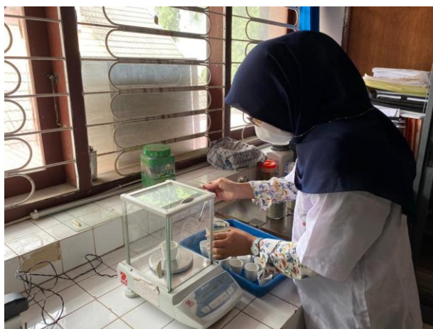
Gambar 28. Menimbang sampel setelah pembakaran menggunakan tanur
