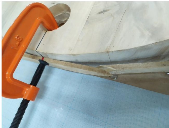
3. Gambar L3.5 Kayu Jati Putih Yang Patah Saat Di lengkungkan
