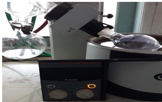
Gambar 2: Evaporasi Ekstrak Etanol
