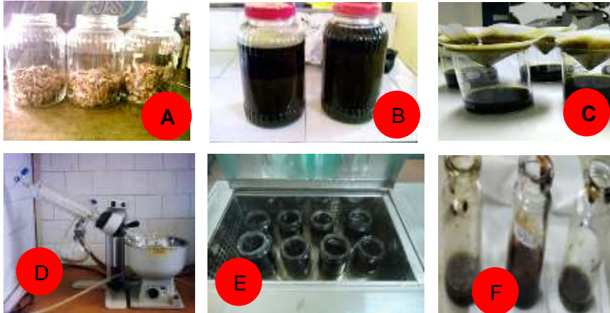
Gambar lampiran 2. Proses Ekstraksi Tanaman : (A) Persiapan Sampel Tanaman, (B) Maserasi, (C) Penyaringan, (D) Rotarievaporator Ekstrak, (E) Penguapan Ekstrak Dengan Waterbath, (F) Grude Ekstrak Tanaman
