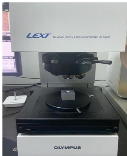
**Gambar 2.2** CLSM ( CONFOCAL LASER SCAN MICRO SCOPY) alat pengukur kekasaran permukaan. LAB TEKNIK METALURGI UNHAS GOWA. Dokumen Pribadi.
