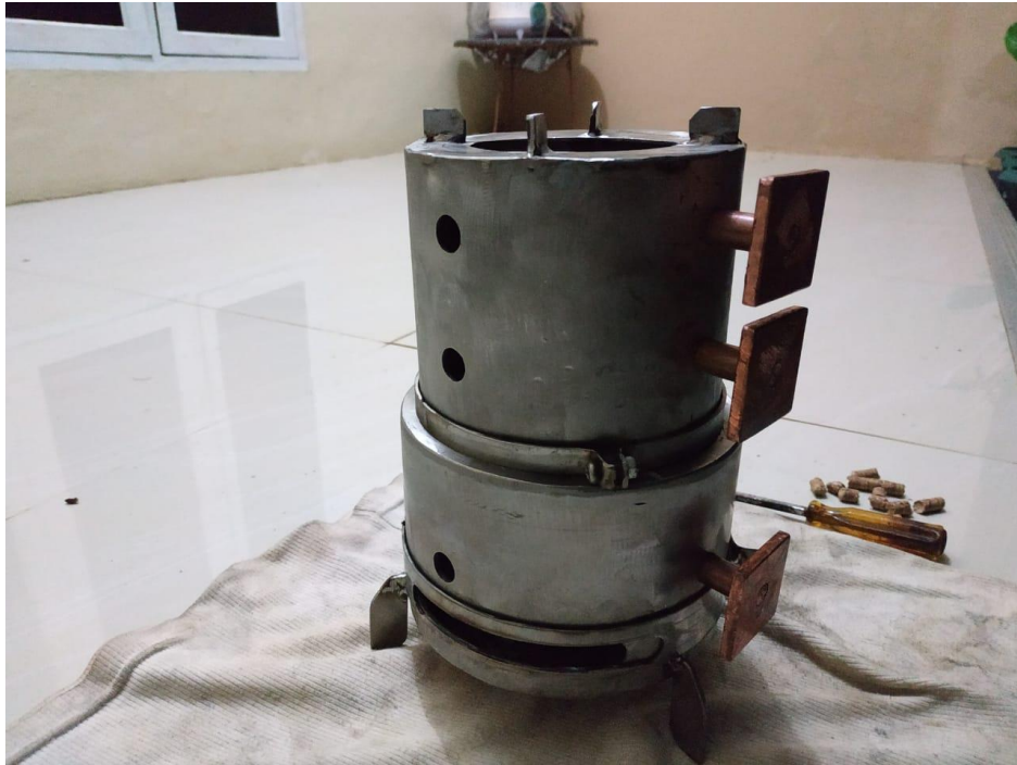
Gambar B3: Kompor saat dipasangkan tembaga
