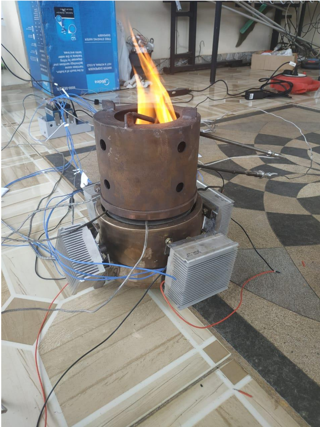
Gambar B8: Pengambilan data dengan variasi 4 tembaga bawah
