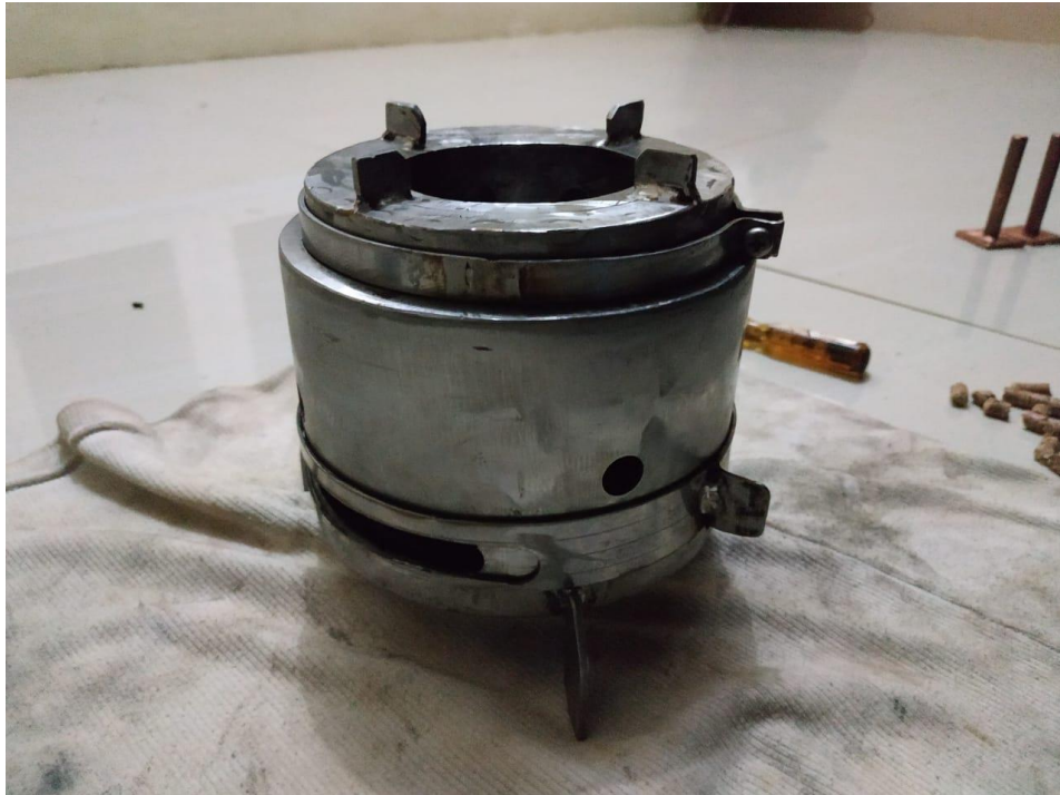
Gambar B1 : Kompor ketika diperkecil untuk mudah dibawa kemana-mana
