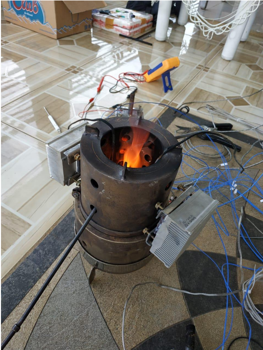
Gambar B7: Pengambilan data dengan variasi 2 tembaga tengah
