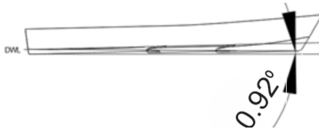
Gambar Kondisi trim 0,92^\circ model kapal 2 Stepped W dengan V 1,232 m/s
