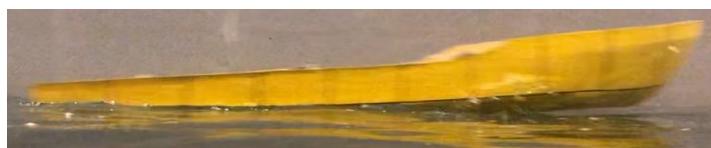
Gambar Model kapal 2 Stepped V dengan V sebesar 2,542 m/s
