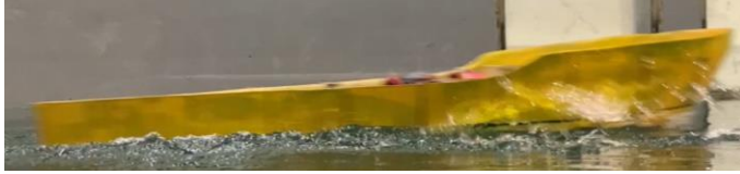
Gambar Model kapal 2 Stepped W dengan V sebesar 2,092 m/s
