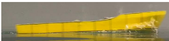
Gambar Model kapal 2 Stepped 2-U dengan V sebesar 2,571 m/s
