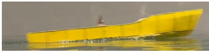
Gambar Model kapal 2 Stepped 2-U dengan V sebesar 3,704 m/s
