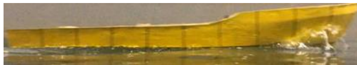
Gambar Model kapal 2 Stepped V dengan V sebesar 1,26 m/s
