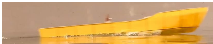
Gambar. Model kapal 2 Stepped U dengan V sebesar 3,559 m/s
