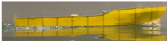
Gambar Model kapal 2 Stepped 2-U dengan V sebesar 1,282 m/s
