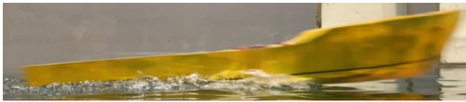
Gambar Model kapal 2 Stepped W dengan V sebesar 2,564 m/s
