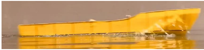
Gambar Model kapal 2 Stepped U dengan f_n V sebesar 2,404 m/s
