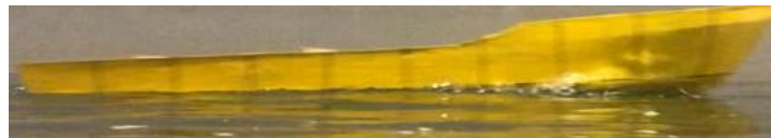
Gambar Model kapal 2 Stepped V dengan V sebesar 2.083 m/s
