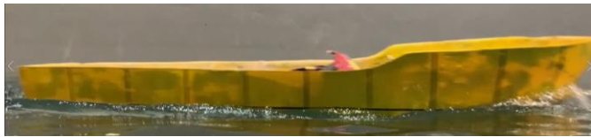
Gambar Model kapal 2 Stepped W dengan V sebesar 1,232 m/s
