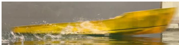
Gambar Model kapal 2 Stepped W dengan V sebesar 3,745 m/s
