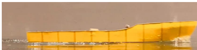
Gambar Model kapal 2 Stepped U dengan V sebesar 1,241 m/s
