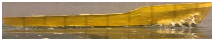
Gambar Model kapal 2 Stepped V dengan V sebesar 1,35 m/s
