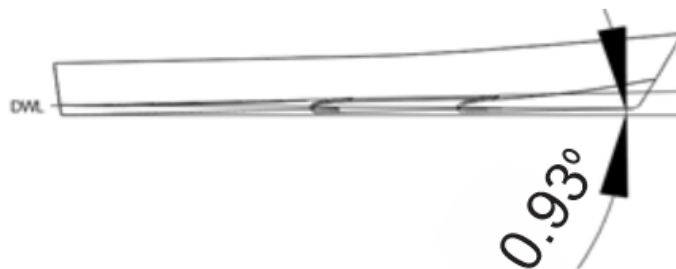
Gambar Kondisi trim 0,93 ° model kapal 2 Stepped V dengan V 1,26 m/s
