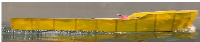
Gambar Model kapal 2 Stepped W dengan V sebesar 1,325 m/s
