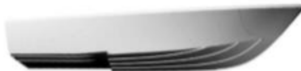
Gambar 2.8. Kapal planing dengan Stepped melintang.
